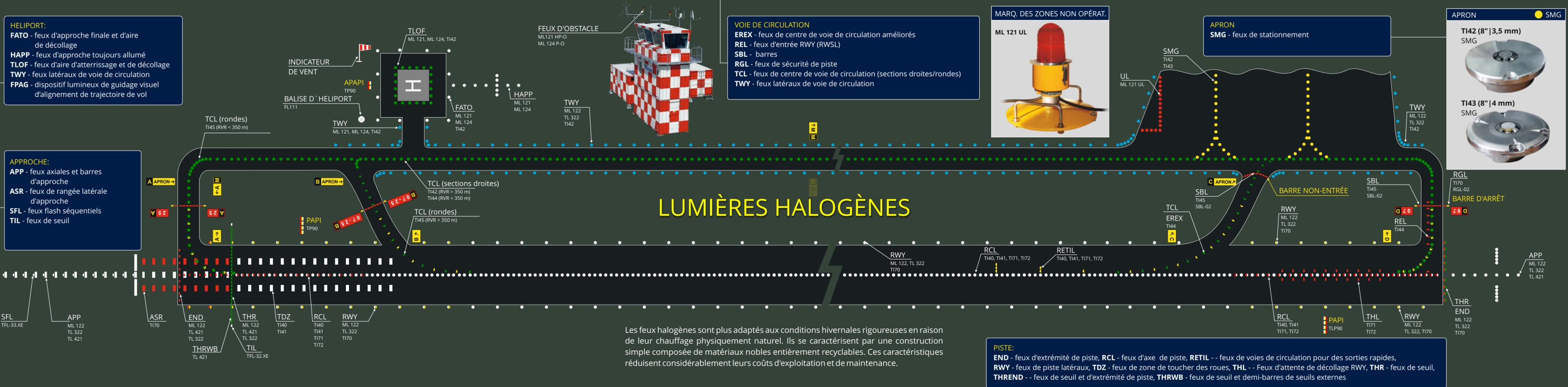
Les feux halogènes sont plus adaptés aux conditions hivernales rigoureuses en raison de leur chauffage physiquement naturel. Ils se caractérisent par une construction simple composée de matériaux nobles entièrement recyclables. Ces caractéristiques réduisent considérablement leurs coûts d'exploitation et de maintenance.
