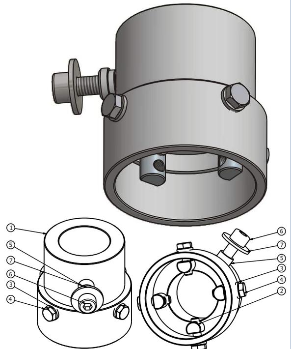
1. адаптер из трубки диаметр 60 мм для огней EL 217 SFL
